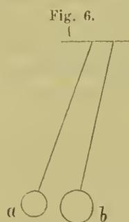
die leichtere Kugel *a* vermöge ihrer Elasticität zurückprallt. Sie sehen leicht ein, dass die Folge davon ist, dass die beiden Kugeln auseinanderfliegen, und wenn ich sie jetzt gegen einander verschiebe, so werden Sie bemerken, dass sie im entgegengesetzten Sinne schwingen, wie dies Fig. 7 darstellt.
